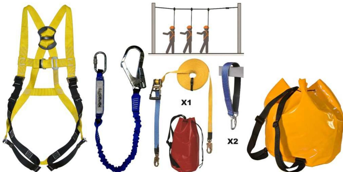
Kit prêt à l'emploi qui s'adapte aux structures d'accueil grâce à la ligne de vie réglable en longueur avec son tendeur à cliquet et ses deux sangles d'amarrage renforcées (utilisable par 3 personnes simultanément). Longe antichute extensible s'adaptant en fonction de l'évolution de l'utilisateur sans jamais le gêner dans ses déplacements. Activité : évolution sur ligne de vie, construction BTP, maintenance industrielle.
