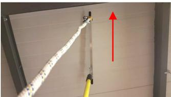
Emboîter le passe cordage sur la tête UDI HPDT800 ou HPDT900. Assembler l'ensemble à la perche télescopique HPDT200. Positionner l'anneau acier sur le crochet avant du passe cordage. Déployer la perche jusqu'à la hauteur de la poutre à atteindre.
