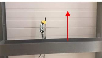
Enfourner le passe cordage dans l'espace au dessus de la poutre pour transférer le lest, le mousqueton de sécurité et la tête de cordage de sécurité du côté opposé.
