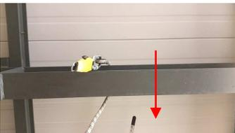
Faire chevaucher le passe cordage sur la poutre en le ramenant tranquillement en arrière. Le lest doit se bloquer côté opposé de la poutre et se dissocier du crochet avant du passe cordage.
