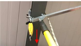
Récupérer le lest et le cordage de sécurité en passant le crochet arrière dans le mousqueton de sécurité. Replier la perche sur elle-même et ramener par la même occasion la tête du cordage vers le sol jusqu'à votre niveau.
